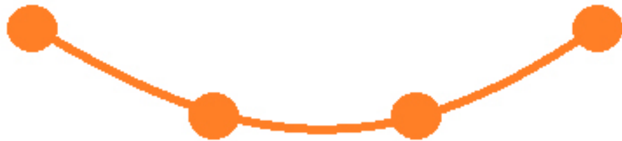
Abbildung 3.2: Die Abbildung zeigt ein Linienmodell, welches auf dem Snake-Modell basiert. Die Snake-Punkte sind als orange Punkte dargestellt, die verbindenden orangen Linien dienen nur zur Visualisierung der Topologie.
