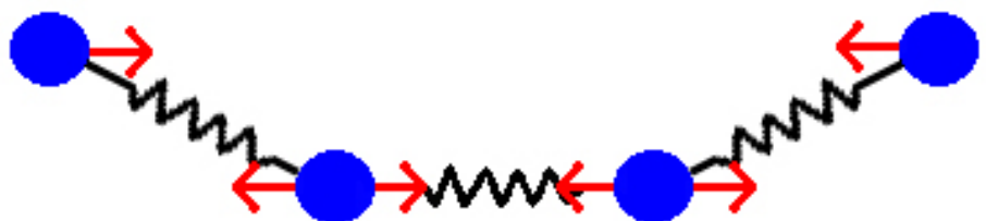
Abbildung 3.1: Die Abbildung zeigt ein Linienmodell, erzeugt auf Grundlage des Feder-Masse-Modells. Die roten Pfeile repräsentieren die Ruherichtungen der Federn.
