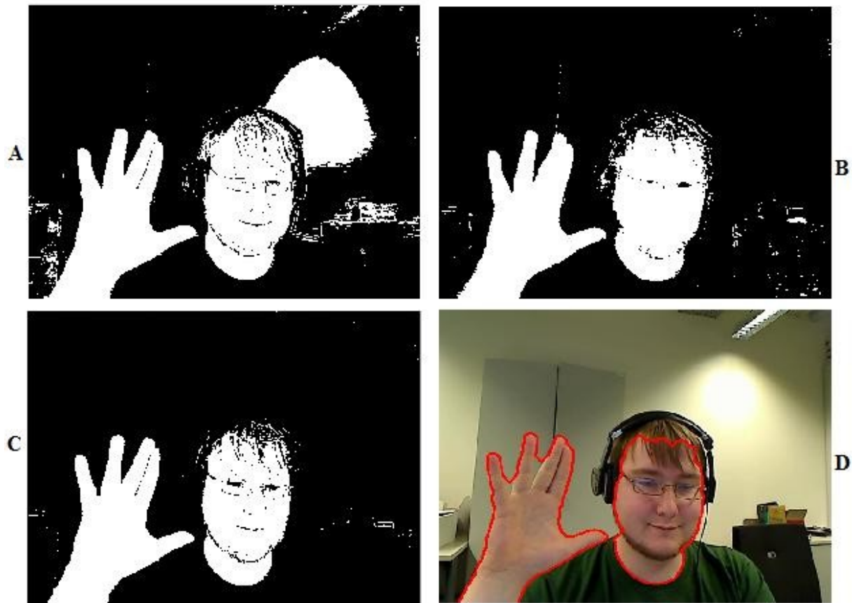
Abbildung 5-4 - Hautfarbenerkennung - A: RGB-Segmentierung, B: HSV-Segmentierung, C: Segmentierungsbild, D: Regionen nach Morphologie
